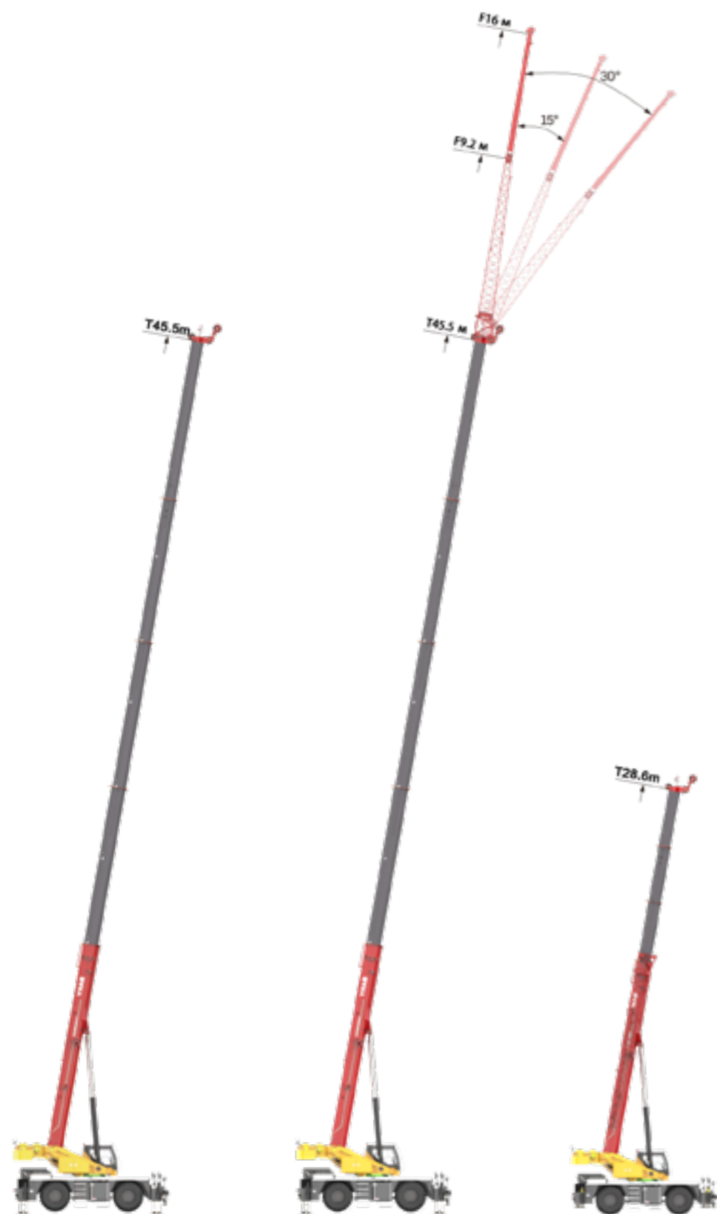
Кран с полностью выдвинутой стрелой на выносных опорах
